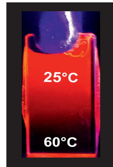
Рис. 3: Люминесцентная визуализация распределения температуры.
